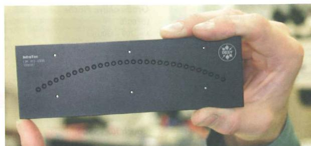
In Zusammenarbeit mit dem Institut „Deutsches Elektronen-Synchrotron DESY“ hat InfraTec eine 30-elementige pyroelektrische Zeile (LIM-107) entwickelt, welche Synchrotron-Strahlung im Terahertz- und Millimeterwellenbereich in einem Spektrometer detektiert.
